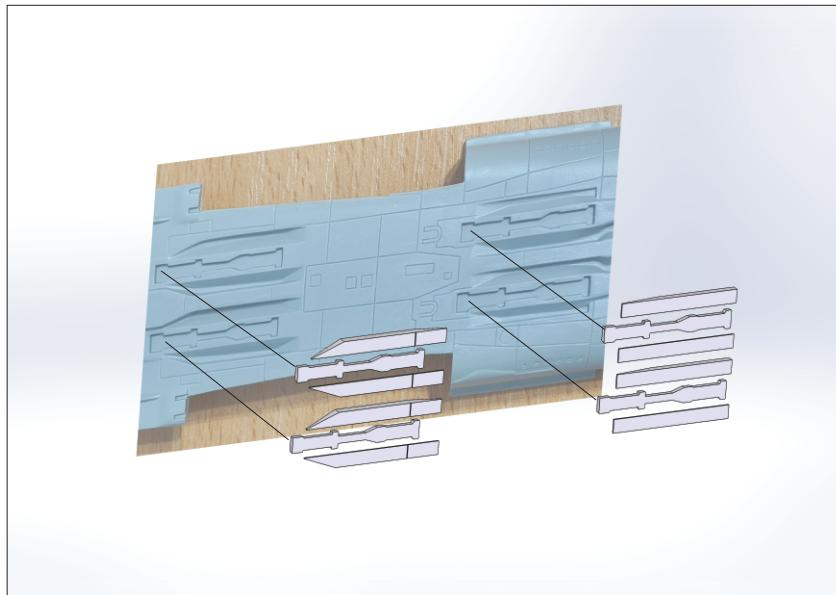
**1. Установить печатные заглушки на корпус самолета. Клеить на суперклей, при необходимости использовать шпатлевку и надфили.**
