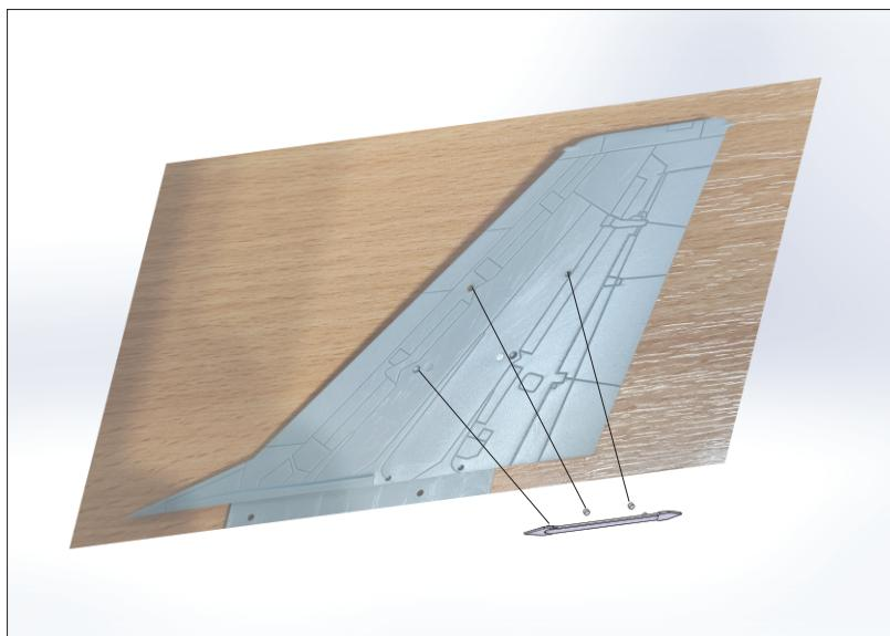
**2. Установить печатные заглушки на крыло (зеркально) самолета. Клеить на суперклей, при необходимости использовать шпатлевку и надфили.**
